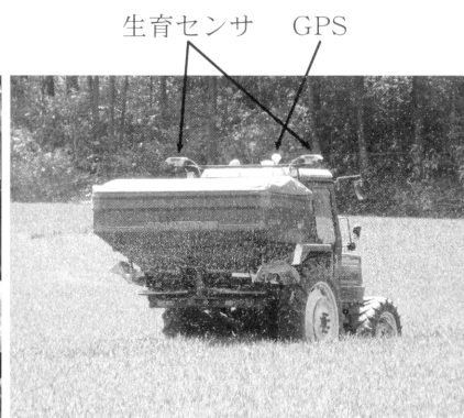
写真3. センシング後の可変施肥作業
